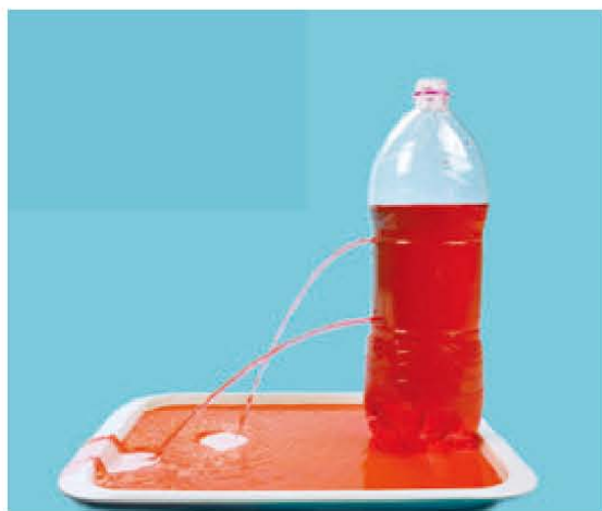
图9.2-1 液体从容器侧壁的孔中喷出
